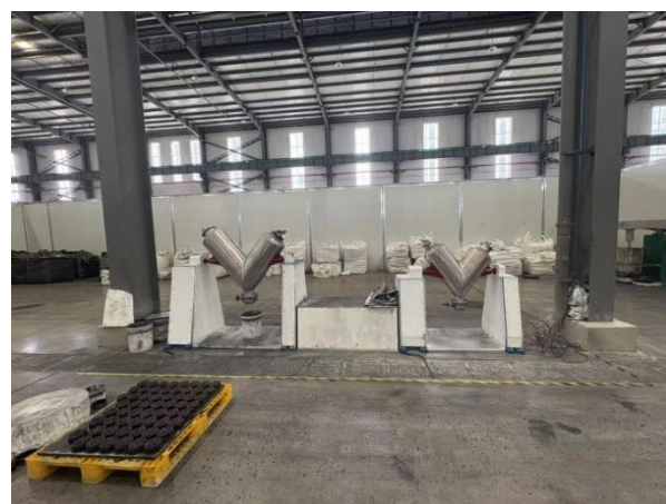
投料搅拌设备（一）
